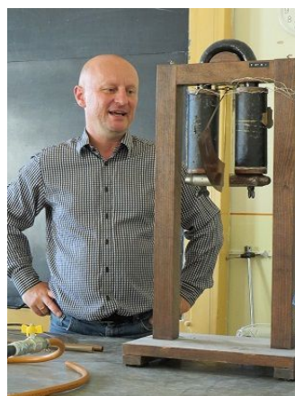
Waltenhofen-inga a Foucault-áramok kimutatásához, 1938 http://bgrg.hu/Files/fiz/FizikaWeblap/elektromossagmagnesesseg/magnesestervakuumbananyagban/waltenhofen.html
